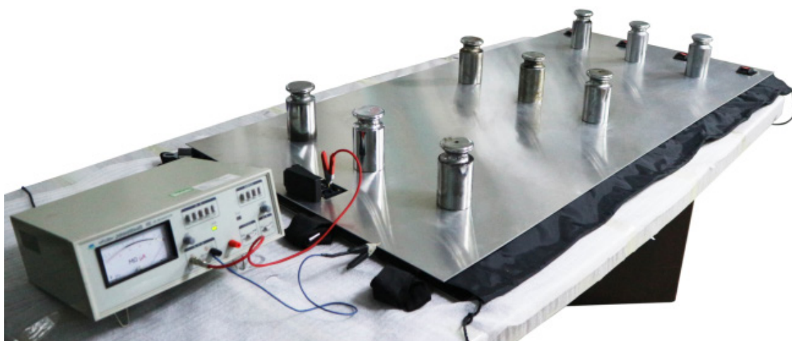
Dispositif de mesure de la résistance d'isolement. Les valeurs mesurées sont toujours supérieures à 0.1Gohm
