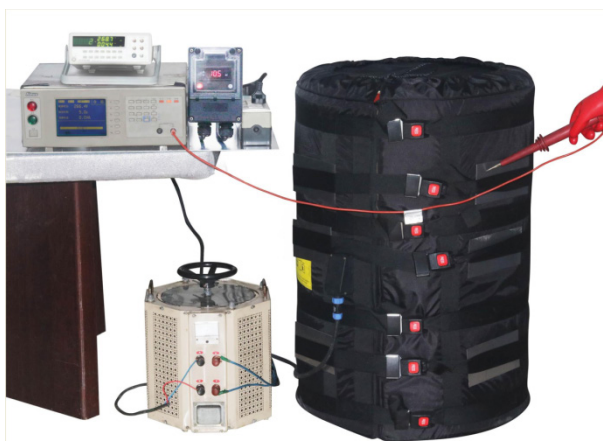
Dispositif d'essai de mesure du courant de fuite à chaud
