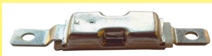
Thermostat Portage Electric type E, rupture lente, pour couvertures chauffantes (1991)
